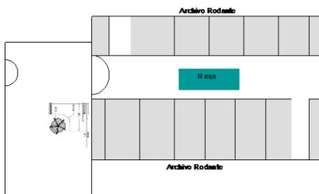
Los estantes rodantes que contienen los expedientes del Archivo Central son metálicos Cold Rolled calibre 22 de 2.20cm de alto, recubierta con pintura electrostática y a los lados con láminas de madera.
